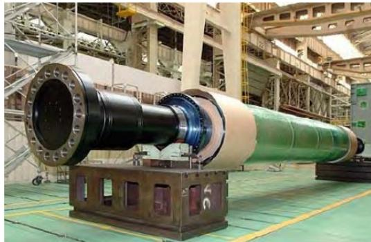
図 40 タービン発電機の回転子例
