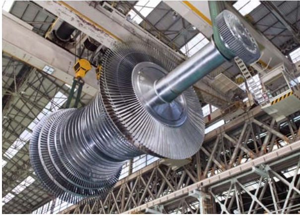
図 17 蒸気タービン (1,000MW) (画像提供：三菱日立パワーシステムズ株式会社)
